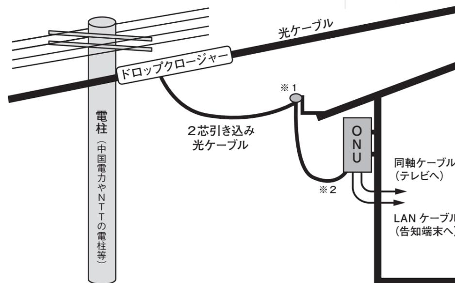
お近くの電柱から“2芯引き込みケーブル”により軒下のONU(光信号から電気信号への変換器)へ接続します。
