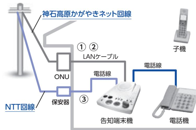
1台の電話で、①町内IP電話、②町外IP電話、③固定電話など、最大3つの電話が使えるようになります。左図のように、上記①と②は神石高原かがやきネット回線を、③はNTT回線を利用します。
