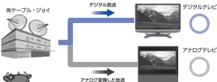
デジアナ変換は、(株)ケーブル・ジョイで地上デジタル放送をアナログ放送に変換して再送信するものです。
