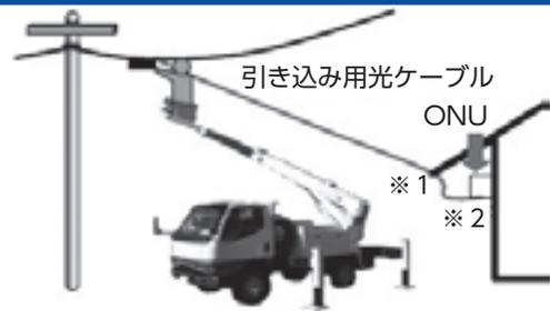
お近くの電柱から“引き込み用光ケーブル”により軒下のONUへ接続します。
