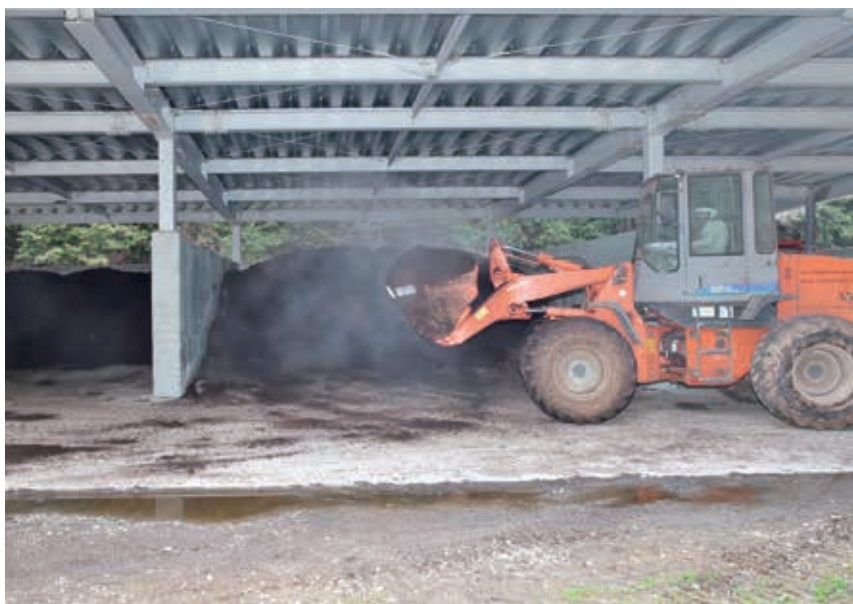
堆肥の切り替えし作業（神石地域堆肥センター）
