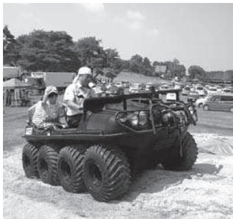
導入予定の水陸両用車 水上を最高速度4kmで進む
